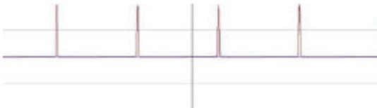
**obertonreiche Schwingung** - hier eine 'pulsbreitenmodulierte Sägezahnschwingung', also ein Sägezahn, dessen Anlauf­flanke verschoben und verkürzt wurde.
